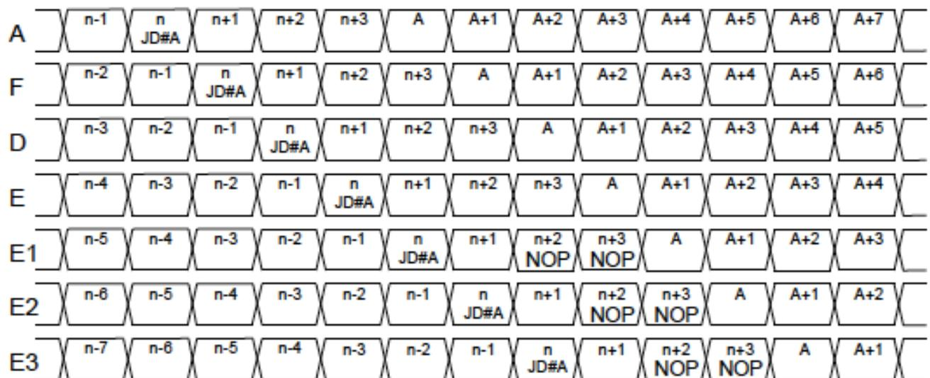
**Рисунок.7.3. Работа программного конвейера при отложенных программных переходах (команды JD (BD) #A). Примечание - A – адрес перехода**
