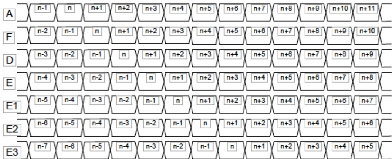
Рисунок.7.1. Работа программного конвейера при последовательной выборке команд
