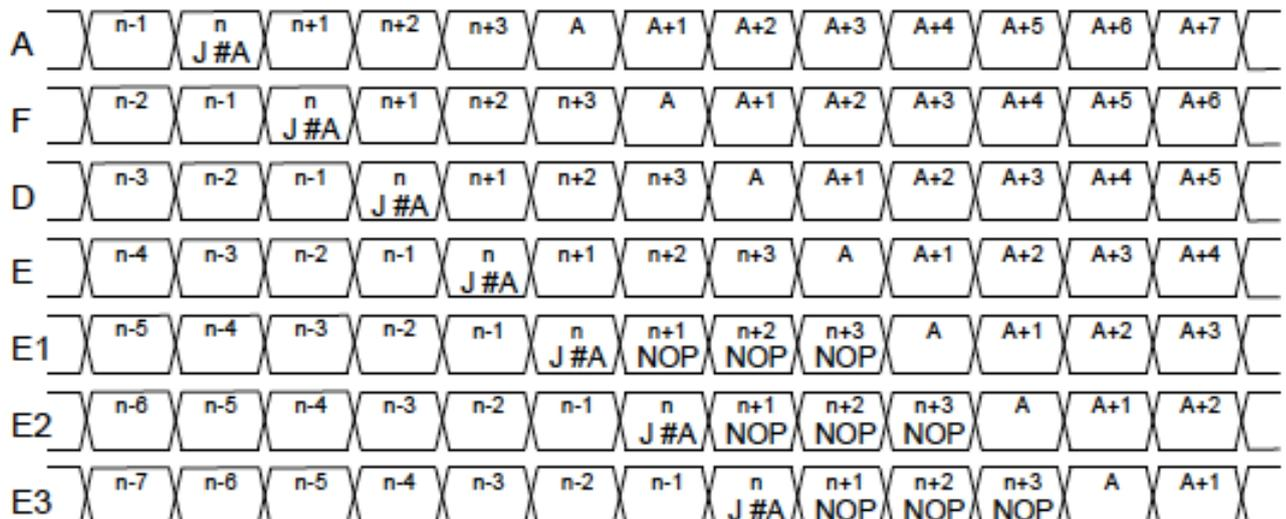
Рисунок. 7.2. Работа программного конвейера при программных переходах (команды J (B)
