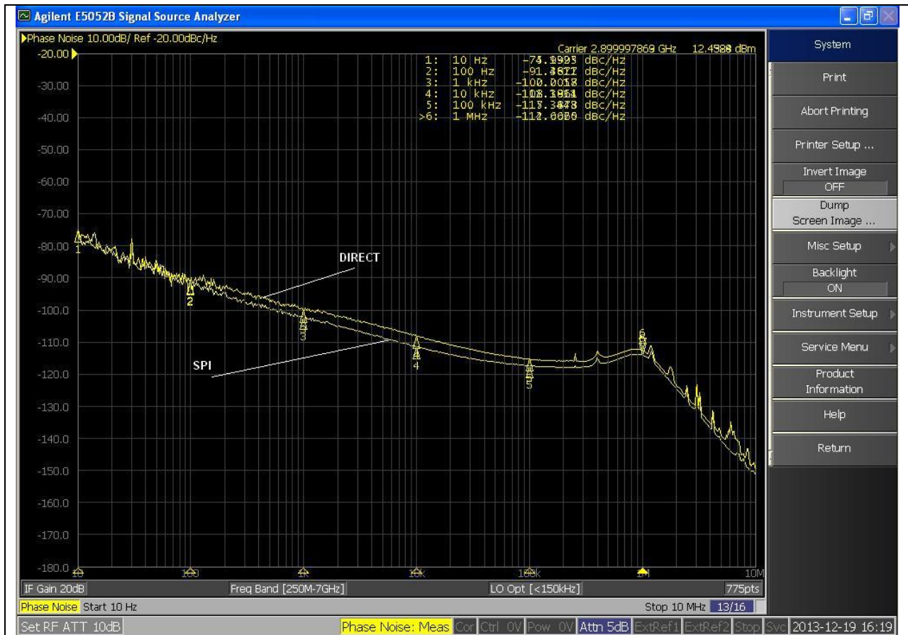
Рисунок 4.5. Спектрограмма фазовых шумов ГУН ROS-3080-1PH19+ в кольце ФАПЧ. ( F_{IN}=2,9 ГГц, F_{REF}=50 МГц, CPI=7 , DLY=0 , R_{set}=3,9 кОм). Верхний график – режим DIRECT, нижний график – режим SPI
