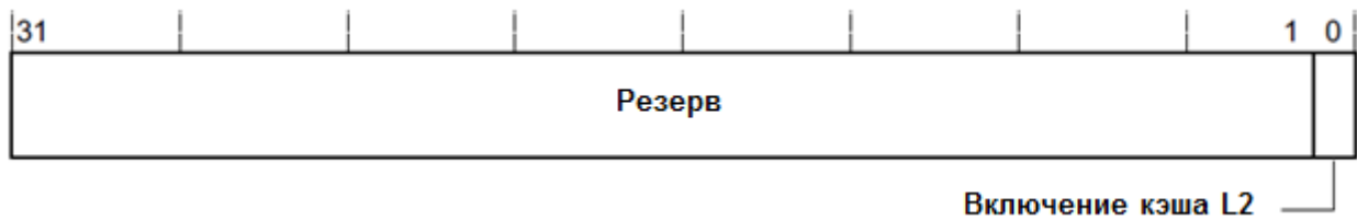
Рисунок 3.33. Назначение разрядов регистра управления
