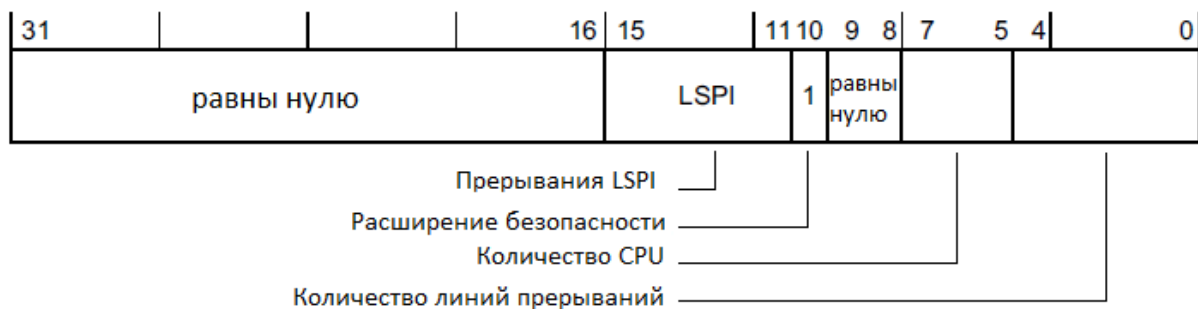
Рисунок 3.16. Назначение разрядов регистра типа контроллера прерываний
