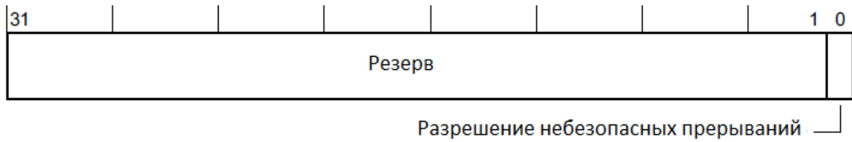
Рисунок 3.15. Описание разрядов регистра управления распределителем для небезопасных обращений
