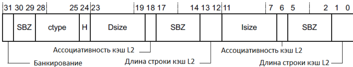
Рисунок 3.32. Назначение разрядов регистра типа кэш-памяти
