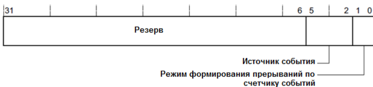
Рисунок 3.37. Назначение разрядов конфигурационных регистров счетчиков событий
