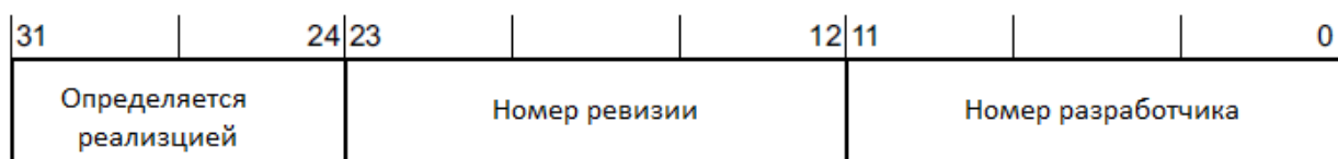
Рисунок 3.17. Назначение разрядов регистра идентификации реализации контроллера
