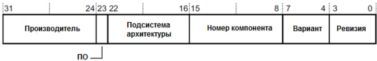
Рисунок 3.27. Назначение разрядов регистра FPSID
