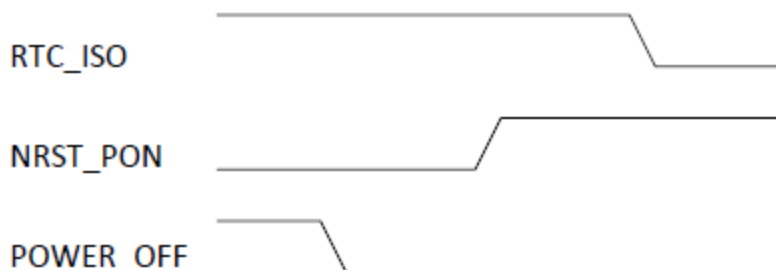
Рисунок 2.12. Последовательность выхода из спящего режима
