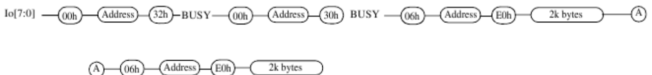
Рисунок 17.12. Ускоренное чтение двух блоков памяти из одного LUN
